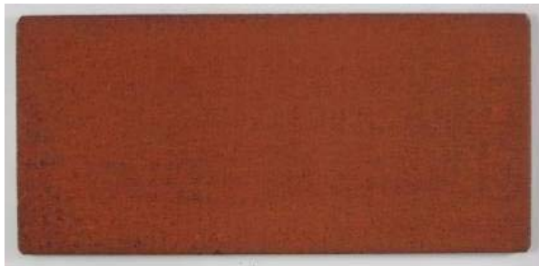
写真5 3種ケレン後鋼板
